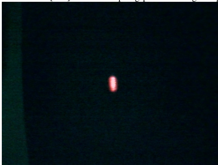
Bild 2: Laserdiode 160[mm] vor der Dämpfungsplatte – stark gedämpft
