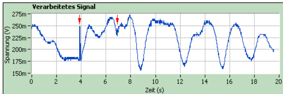
Abbildung 14: Messsignal am Detektoreingang für das Interferometer „1“ nach einer elektrischen Anregung von 10V am Piezo. Ein- und Ausschaltvorgang als „↓“. Quelle: Eigene Messung.
