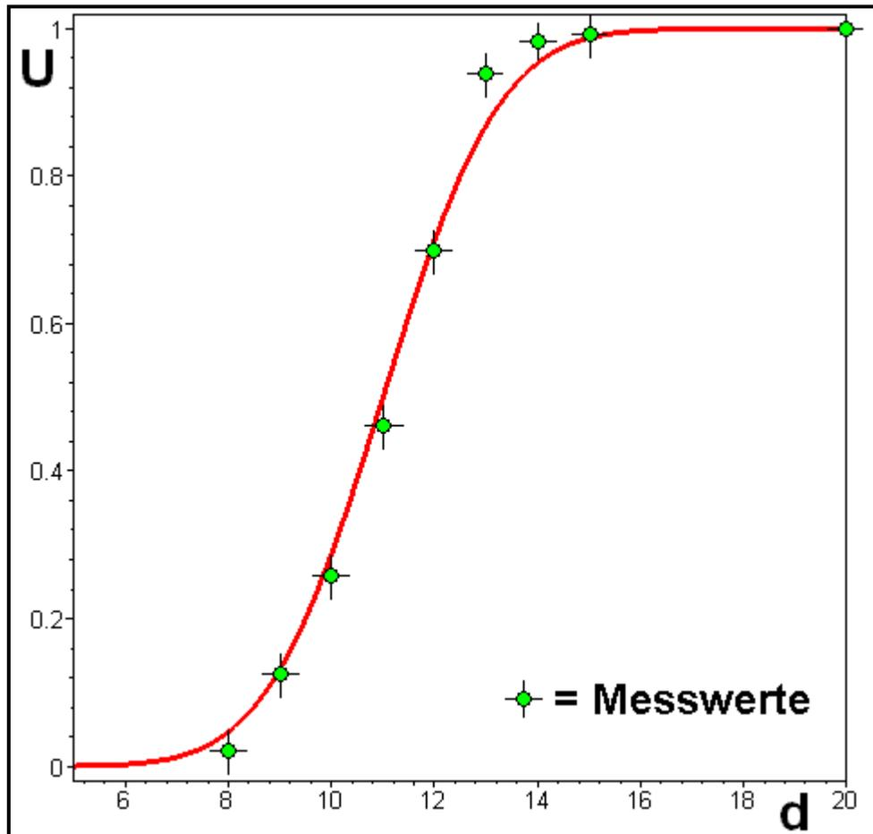
In der Einheit [db] angegeben, ergibt sich somit die Dämpfung pro Windung bei „d“ [mm].
