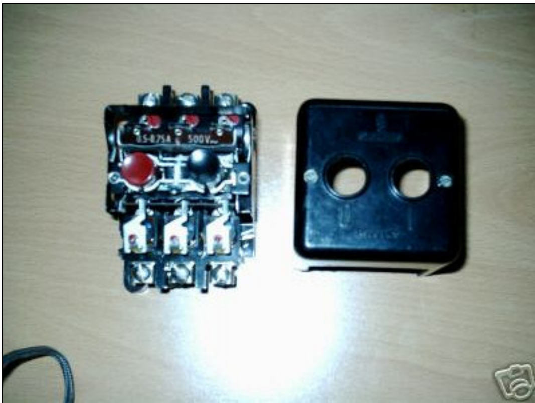
Ein alter Motorschutzschalter von wahrscheinlich Siemens
