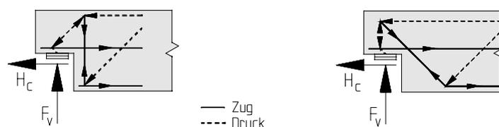
a) Bemessungsmodell bei einer vertikalen
