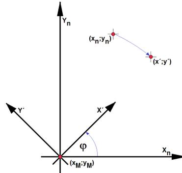
$$\Rightarrow \quad x' = x_n \cdot \cos \varphi + y_n \cdot \sin \varphi \quad y' = y_n \cdot \cos \varphi - x_n \cdot \sin \varphi$$
