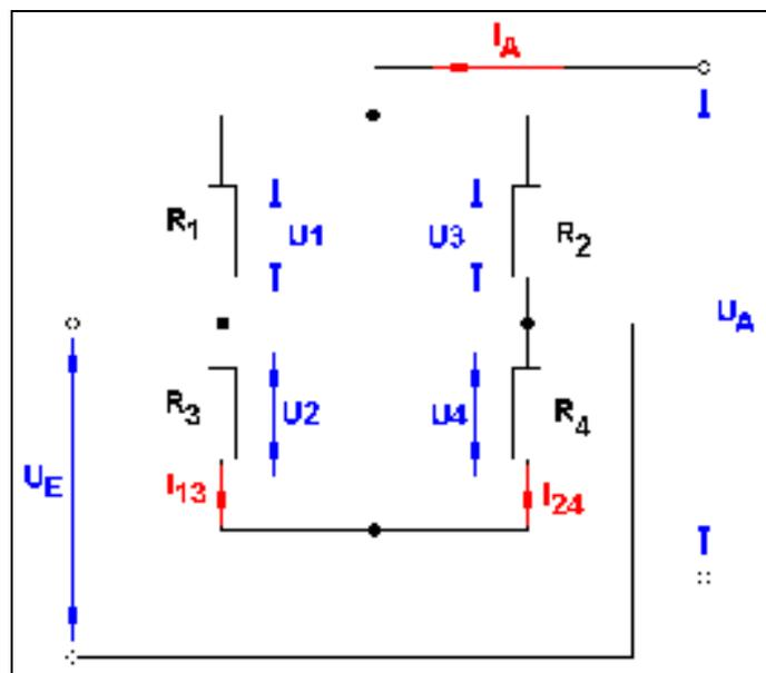
Abbild 1: Die Messbrücke im Allgemeinen mit Strömen und Spannungen.
