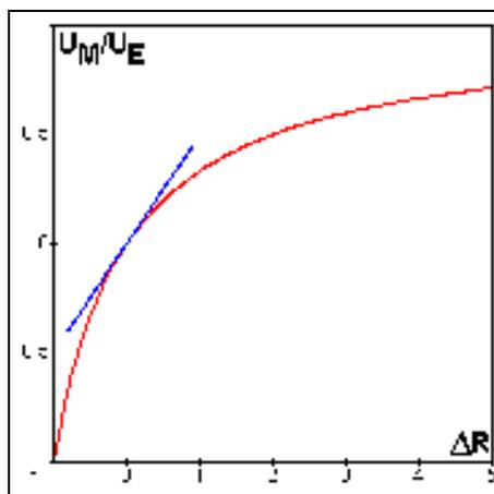
Abbild 6: Die linearisierte Widerstands- Spannungs- Kennlinie (blau) der Viertelbrücke taylorisiert um den Punkt „ $\Delta R = 0$ “ herum.
