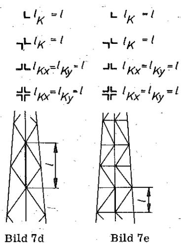
Für die Stabkraft ist der größte Wert und für den Schlankheitsgrad in allen Fällen  $\lambda = l_k / i_{\min}$  einzuführen, wobei  $i_{\min}$  der kleinste Trägheitsradius des Eckstielquerschnittes ist.
